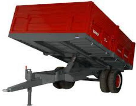
**Üretimi:** Alt dingiller ve makaslar hazır alınır, U demirinden şase üretilir- şase kaldırılır-bükümcüden alınan saç şaseye monte edilir.
