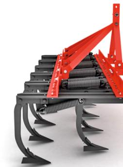
**Üretimi:** Köşebent ve lama demirinden şasesi oluşturuluyor, kesilmiş saçlarla ayaklar yapılır, ayaklara yay takılıp şaseye montajı yapılır.
