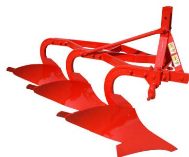
**Üretimi:** Payanda kesimi, şekillendirme ve delik açma, uç demirleri için sac kesim, işleme ve yastağa kaynak yapılması, kulak kesim, son kaynaklama ile montajı tamamlanır.
